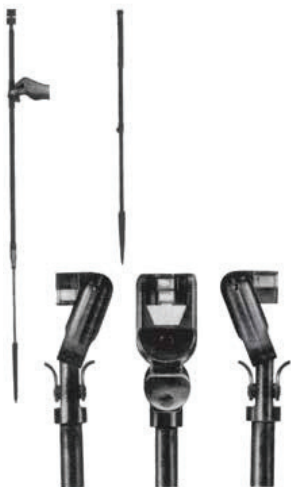
شکل ۸-۳- گونیای منشوری و پایه‌ی مخصوص آن
